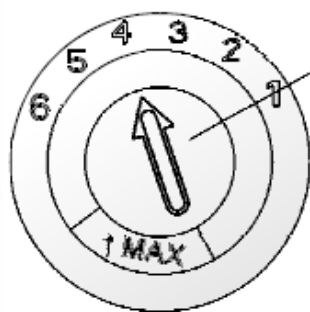
Регулирование расхода ополаскивателя
