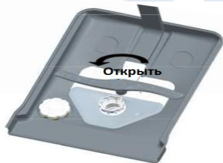
Шаг 1: Поверните фильтр против часовой стрелки.
